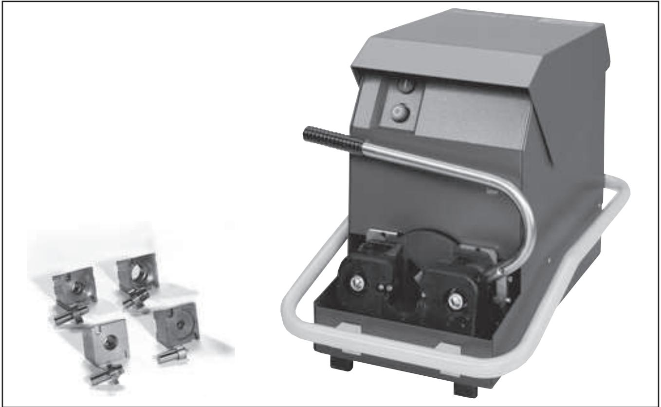
La macchina Parflange® 1025 è progettata per la formatura a freddo di connessioni per tubi O-Lok® e Triple-Lok® ad alta pressione. Essa utilizza il processo di svasatura orbitale Parflange® e comprime uniformemente il materiale del tubo ottenendo una giunzione altamente resistente con una superficie levigata dell'estremità del tubo. Le bussole flangiate O-Lok® e SAE sono saldamente fissate sull'estremità del tubo, realizzando una connessione molto rigida per tubi ad alta pressione.
